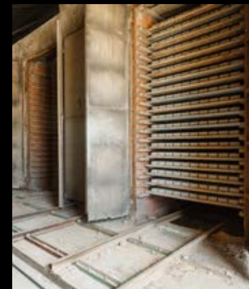
Handvormstenen drogen van binnen uit in de droogkamers
