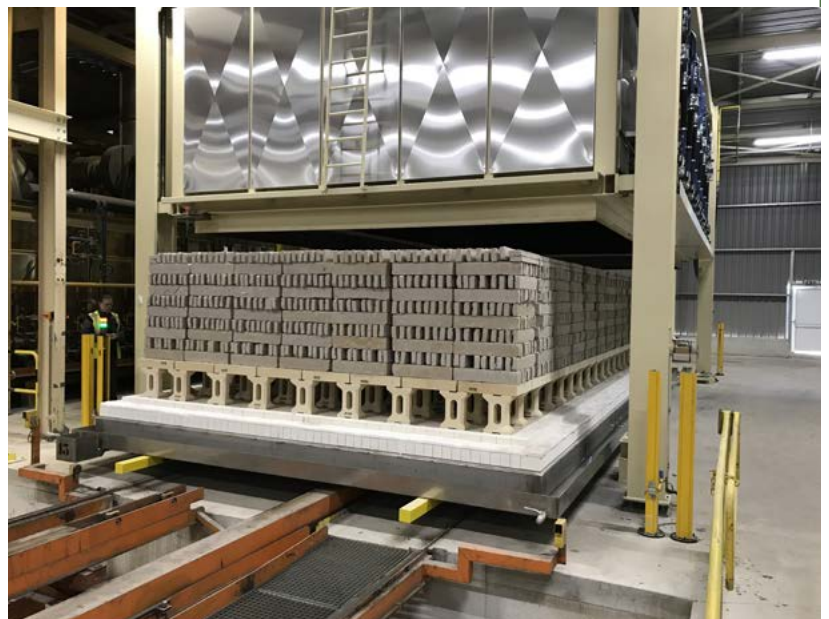
In een smooroven, volledig gevuld met gas, krijgen stenen of dakpannen een andere kleur.
