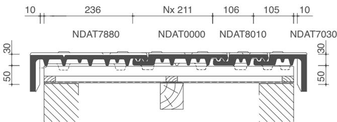
**PLAN DE POSE TRANSVERSALE DE LA TOITURE
