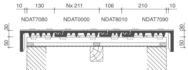
**PLAN DE POSE LONGITUDINALE DE LA TOITURE
