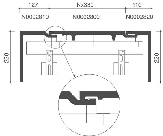
**PLAN DE POSE TRANSVERSALE DE LA TOITURE
