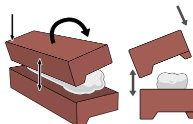
Grâce à l'évidement dans la brique, une couche de mortier classique de 12 mm reste possible.
