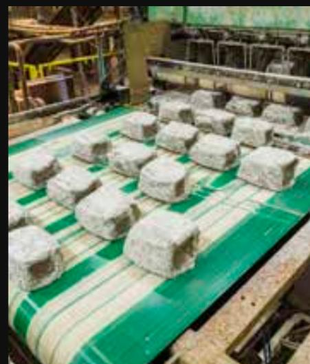
Boules d'argile comprimées prêtes à être moulées
