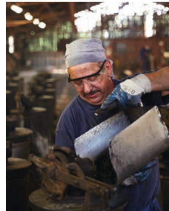
**Le cuiseur.** Le candidat cuiseur apprend le métier sur le tas, comme on dit, en travaillant quelques mois avec un 'ancien'. Le cuiseur se base sur le retrait du tas de briques pour déterminer le stade de cuisson. Son expertise déterminera la qualité de la précuisson, de la cuisson proprement dite et du refroidissement. Une fois le retrait fixé atteint, il arrêtera le processus de combustion.
