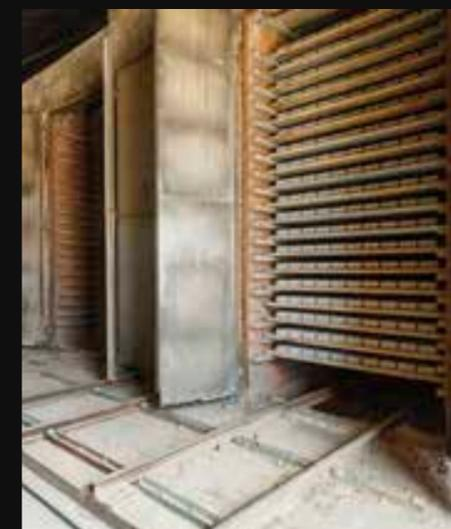
Dans les séchoirs, les briques moulées-main sèchent de l'intérieur
