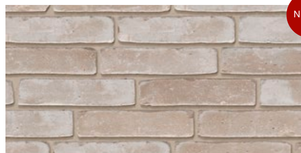
Nubilum Hemelgrijs Porositeit: ≤ 13% Eco-brick WF ± 210 x 65 x 50 mm IW2 - weinig zuigend Eco-brick WDF ± 210 x 65 x 65 mm
