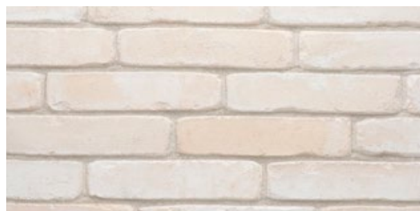
Nubilum Velum Beige Porositeit: ≤ 15% Eco-brick WF ± 210 x 65 x 50 mm IW2 - weinig zuigend
