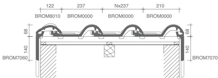
(\*) La distance dépend de l'inclinaison de la toiture ainsi que de la section des lattes et contre-lattes, et doit donc être déterminée sur place.
