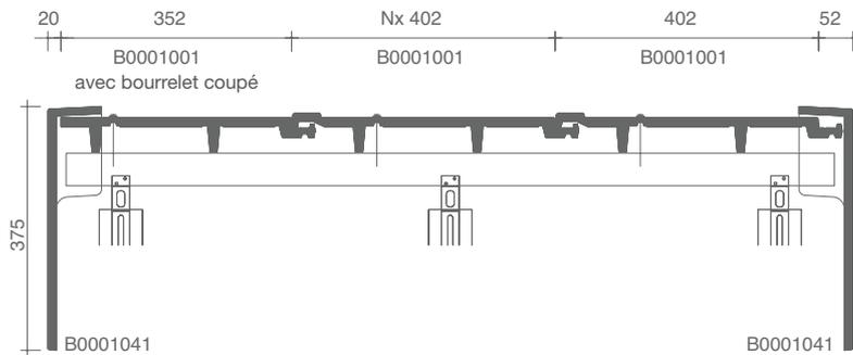
**PLAN DE POSE LONGITUDINALE DE LA TOITURE
