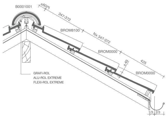
**PLAN DE POSE TRANSVERSALE DE LA TOITURE
