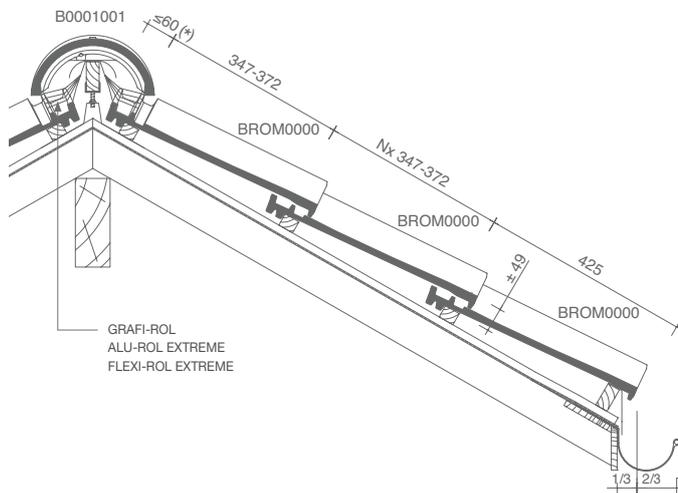
**PLAN DE POSE LONGITUDINALE DE LA TOITURE
