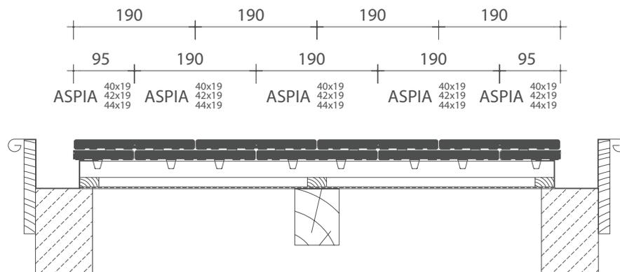
\* Conseil: lors de la pose, les tuiles plates ne doivent pas être comprimées les unes contre les autres ( $\pm 1$  mm de distance), afin d'éviter qu'elles ne s'endommagent consécutivement au tassement de la structure portante.
