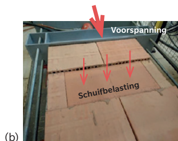
(b) Uiteindelijk testopstelling met schuifbelasting in de lengte. Bij deze opstelling faalde het proefstuk effectief door schuifspanningen (De Cooman & Deforce, 2018).
