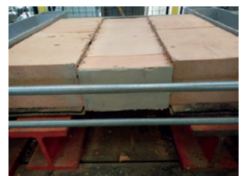
(b) Uiteindelijk testopstelling met schuifbelasting in de lengte. Bij deze opstelling faalde het proefstuk effectief door schuifspanningen (De Cooman & Deforce, 2018).
