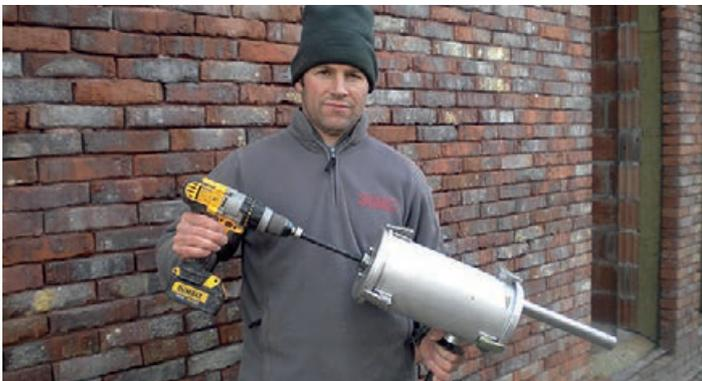
Pistolet mécanique sans pompe (source: Uniconstruct)
