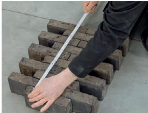
Détermination de l'épaisseur moyenne de la brique
