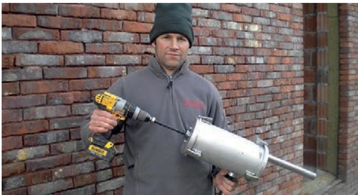
Pistolet mécanique sans pompe (source: Uniconstruct)
