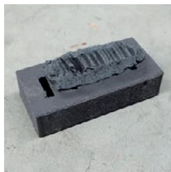
Photo 3: méthode de maçonnerie à joints minces en cas de brique perforée
