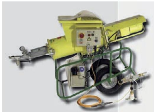
Pistolet mécanique avec pompe
