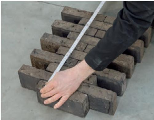
Détermination de l'épaisseur moyenne de la brique
