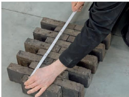
Détermination de l'épaisseur moyenne de la brique
