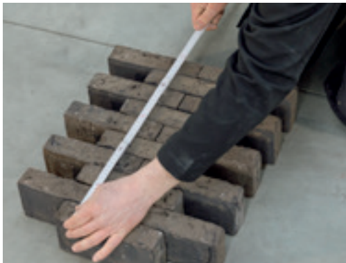
Bepaling gemiddelde dikte van de baksteen
