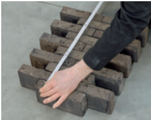
Bepaling gemiddelde dikte van de baksteen
