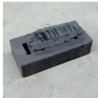
Foto 3: dunbedmortelmethode bij geperforeerde steen
