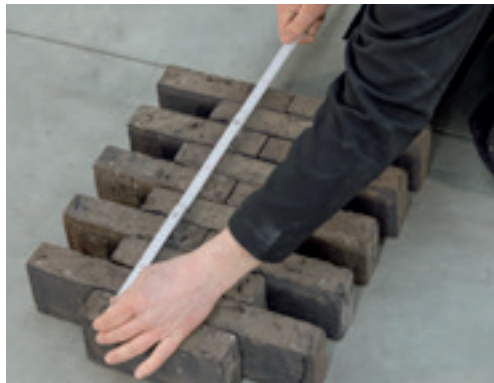
Bepaling gemiddelde dikte van de baksteen
