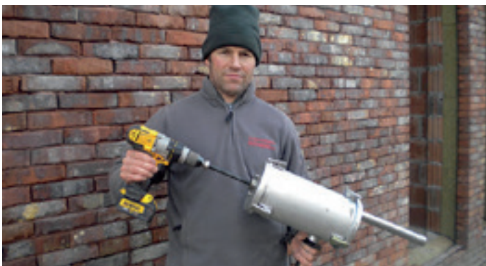
Machinaal spuitpistool zonder pomp (bron: Uniconstruct)
