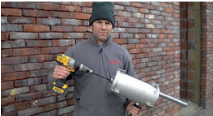
Machinaal spuitpistool zonder pomp (bron: Uniconstruct)
