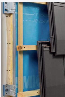
Des profilés aluminium en T et en L seront fixés à la maçonnerie au moyen d'équerres à point fixe et d'équerres à point de dilatation. Pour éviter tout contact thermique entre la paroi extérieure et la paroi intérieure, on appliquera des ruptures thermiques tant entre la façade et l'équerre qu'entre l'équerre et la tête des vis.
