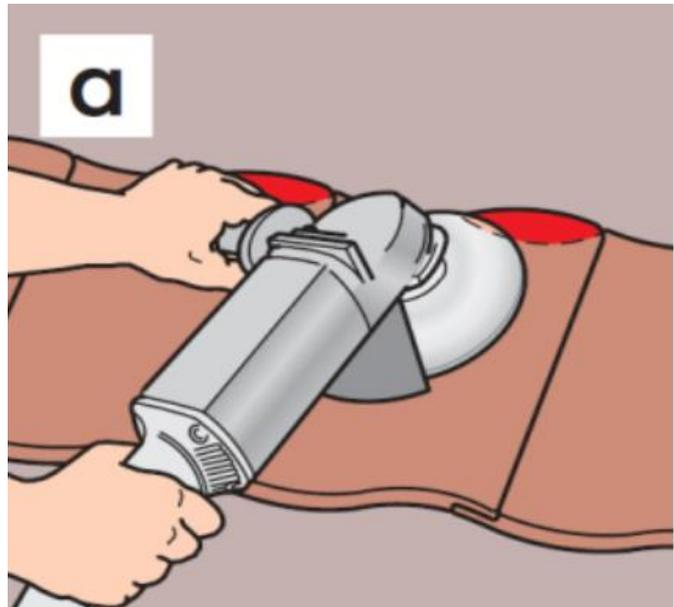
Etape 6: Pour éviter que les tuiles autour de la fenêtre de toit se relèvent lors du montage du profil inférieur, les profils latéraux ou le profil supérieur, il faudra amincir les lattes de 8mm sur toute la largeur ou bien découper les lattes et les rallonger d'une latte sous-jacente plus mince (-8mm).
