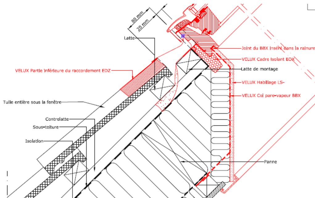
Etape 4: Faites une gouttière au-dessus de la fenêtre de toit afin de dévier l'eau qui se trouverait éventuellement sur la sous-toiture sur les côtés de la fenêtre de toit (à cette fin suivre les instructions du KORAMIC FLEECE et de VELUX).
