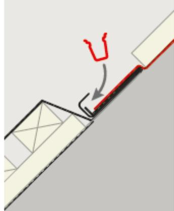
Etape 5: Posez la rangée de tuiles inférieure. Pour une bonne connexion de ces tuiles avec le profil inférieur à bavette plissée, il sera éventuellement nécessaire de découper en oblique l'emboîtement de tête de ces tuiles.
