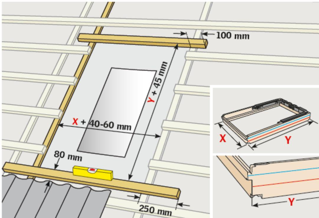
Etape 3: Il faut positionner la fenêtre de toit VELUX 8mm plus profondément. La fixation de la fenêtre de toit (voir illustration ci-dessous & instruction d'installation) en-dessous et au-dessus de la fenêtre de toit se fait par des lattes d'une épaisseur équivalente à l'épaisseur d'une latte – 8mm.
