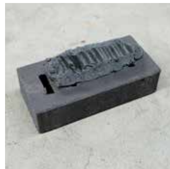
Foto 3: dunbedmortelmethode bij geperforeerde steen
