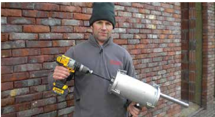
Machinaal spuitpistool zonder pomp (bron: Uniconstruct)
