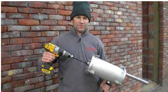
Machinaal spuitpistool zonder pomp (bron: Uniconstruct)
