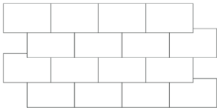
Pose en quinconce
